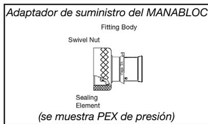
Esta conexión se usa en el suministro de agua fría y en las líneas de suministro/retorno de agua caliente. Esta conexión al MANABLOC no requiere compuesto sellador de roscas y no se debe usar este tipo de sellador.
