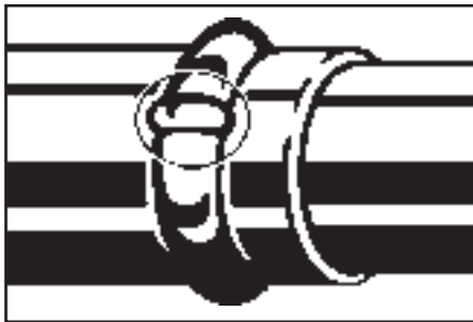
Figura 3.1: La característica Smart Connect® en el conector de prensa Viega esta identificada por una marca circular en color.
