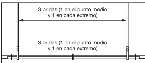
Detalle de sujeción de bandeja con correas
